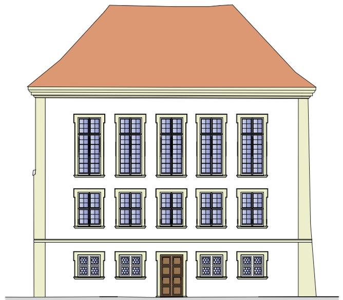
Abb. 3: Hypothetische Rekonstruktion der Südfassade im 1714 geplanten Zustand analog zu den Fassaden des Konventgebäudes. Fenster und Türe in Ebene 0 ohne Befund ergänzt.
